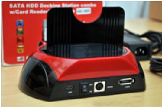
Зачем нужен такой девайс? - спросите Вы. Действительно, рядовой пользователь вполне может обойтись без такого устройства. Но в нашей сфере без док-станции представить свою жизнь сложно. **Задача 1.** Переписать всю информацию с стационарного ПК на ноутбук. Отсоединяем HDD от большого брата и через USB или eSATA включаем док-станцию к ноутбуку. Вся процедура занимает гораздо меньше времени если бы Вы, скажем, пытались передать все файлы по локальной сети или с помощью флешки!
